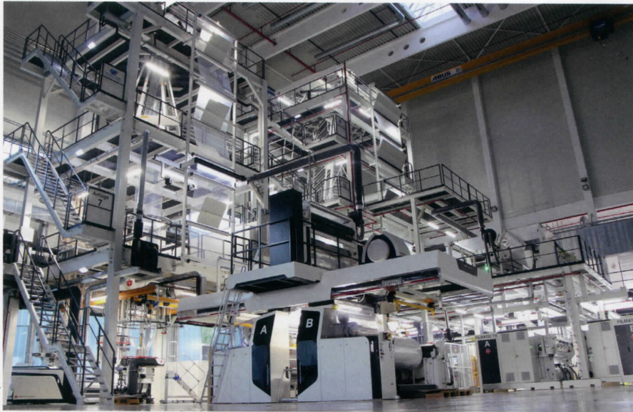
▲ 2013 wurde in der neuen Produktionshalle eine 9-Schicht-Blasfolien-Coextrusionsanlage mit 31 Förderabscheidern in Betrieb genommen. 2016 kam eine weitere 3-Schicht-Blasfolien-Coextrusionsanlage hinzu.
