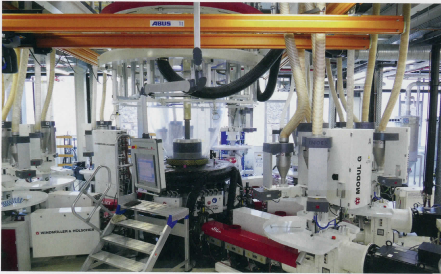
▲ Die Materialien werden aus den jeweiligen Quellen zur Coextrusionsanlage transportiert.
