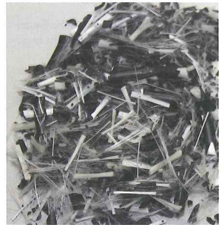
Bild 5. Gut imprägnierte LFT-Typen bleiben bei mechanischer Belastung weitestgehend unversehrt (links), lediglich mit Matrixmaterial grob ummantelt zerfällt der Verbund, und lose Fasern werden in großem Umfang sichtbar (rechts)
