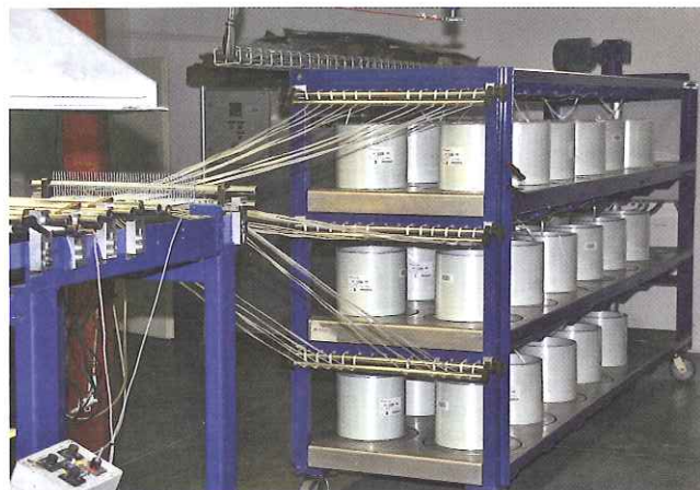
Bild 2. Pultrusionsanlage, bestehend aus Spulengatter zur Aufnahme und Abwicklung der Faserspulen (1), Spanneinrichtung mit Kämmen zum Führen und Spannen der Faserstränge (2), Extruder zur Schmelzaufbereitung (3), Werkzeug zum Imprägnieren der Fasern mit der Polymerschmelze (4), intensivierte Kühlung (5), Vorrichtung (Puller) zum Spannen und Ziehen der Faser-Polymer-Stränge (6), Granulator (7), Konfektionierung (Abpacken oder Silofüllung) des LFT-Granulats (8), Rohstoffzuführung aus Silo, Big Bag o.Ä. (9), Extruderbeschickung aus dem Trockner bzw. Dosiersystem (10)
