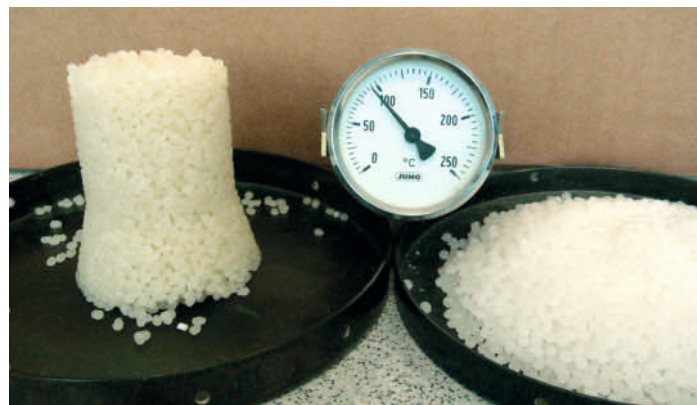
Bild 1. Klebetest an PLA-Granulat: Bei 100 °C bleibt die teilkristalline Spritzgießtype Ingeo 3251D rieselfähig (rechts) – bei einer amorphen PLA-Type (links) zerfällt die durch Verkleben der Granulatkörner entstandene zylindrische Säule nach dem Entfernen des Metallzylinders nicht
