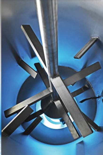
SOMOS® Kristallisatoren gibt es in unterschiedlichen Baugrößen (im Bild links die Baugröße K200 für Durchsätze bis zu 300 kg/h im ATG-Verfahren). Sie werden mit Warmluft betrieben und haben ein Rührwerk (Bild rechts), das ein Verkleben der Partikel beim Durchlaufen der Glasübergangstemperatur verhindert.
