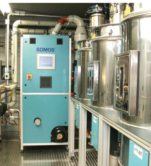
Die SOMOS® Trocknungsanlage bei FWB (Bild links) hat fünf Trocknungstrichter, geplant ist die Erweiterung auf bis zu sieben Trichter. Die getrockneten Materialien werden in maschinenbezogenen Leitungen staubfrei zu den Spritzgießmaschinen im Sauberraum (Bild rechts) gefördert. Da auch abrasive Granulate verarbeitet werden, bestehen die Umlenkungen der materialführenden Leitungen bis zur Anbindung an die Spritzgießmaschinen (Bildausschnitt) aus gehärtetem Glas.
