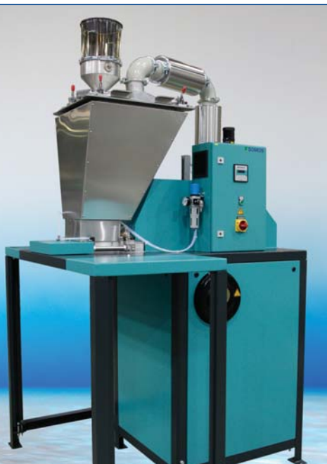
Der im Batchbetrieb arbeitende SOMOS® Wirbelstromkristallisor kann ausschließlich mit amorphem Material beschickt werden.
