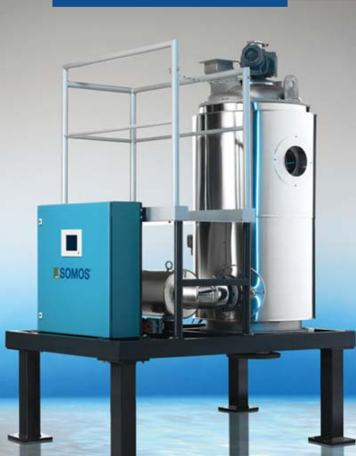
SOMOS® Kristallisatoren gibt es in unterschiedlichen Baugrößen (im Bild links die Baugröße K200 für Durchsätze bis zu 300 kg/h im ATG-Verfahren). Sie werden mit Warmluft betrieben und haben ein Rührwerk (Bild rechts), das ein Verkleben der Partikel beim Durchlaufen der Glasübergangstemperatur verhindert.
