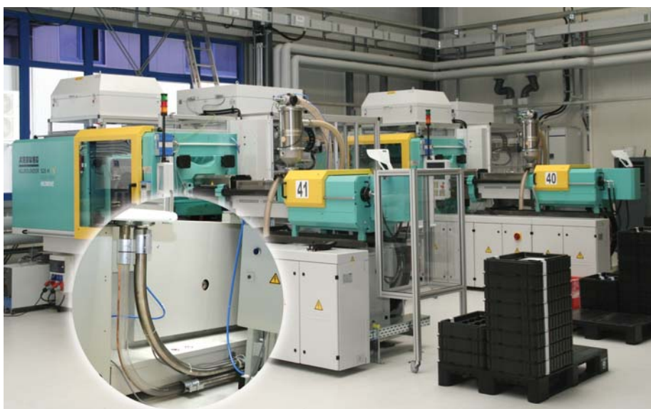
Die SOMOS® Trocknungsanlage bei FWB (Bild links) hat fünf Trocknungstrichter, geplant ist die Erweiterung auf bis zu sieben Trichter. Die getrockneten Materialien werden in maschinenbezogenen Leitungen staubfrei zu den Spritzgießmaschinen im Sauberraum (Bild rechts) gefördert. Da auch abrasive Granulate verarbeitet werden, bestehen die Umlenkungen der materialführenden Leitungen bis zur Anbindung an die Spritzgießmaschinen (Bildausschnitt) aus gehärtetem Glas.
