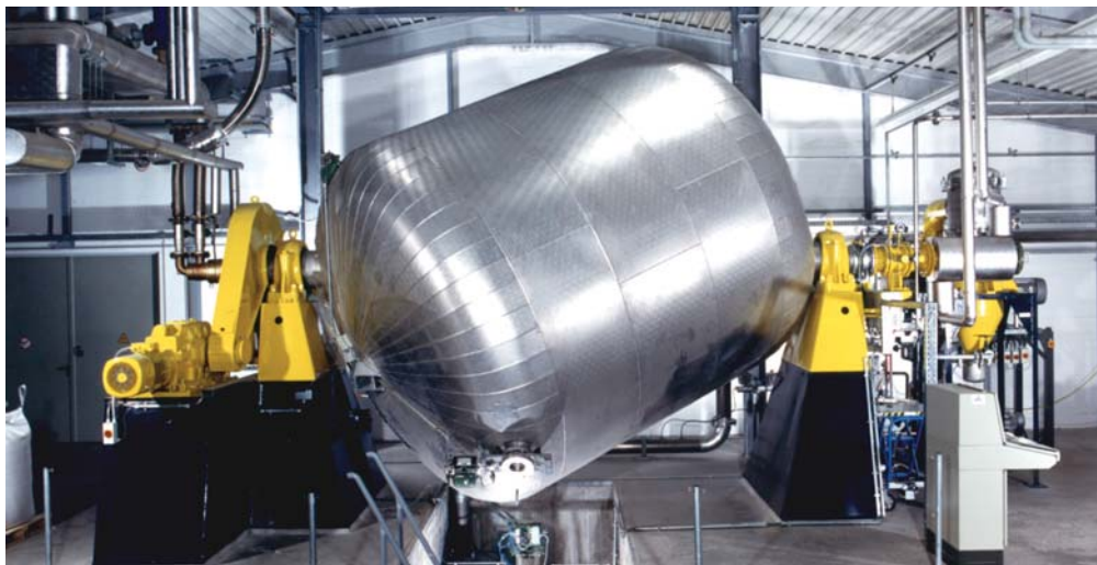
OHL Taumelreaktor, eingesetzt in einer Recyclinganlage zum Dekontaminieren und Nachkondensieren (Erhöhung des IV-Werts) von rPET-Granulat. Verfügbar sind Baugrößen mit einem Volumen bis zu 44 m 3 .
